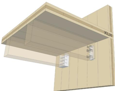
Fig10. : Soporte directo del elemento de forjado en la pared. Los nervios se fijan a la cara de la pared con los elementos de fijación adecuados
